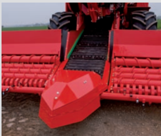
Hydraulisch angetriebener Schiebekeil
