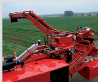
Das Überladeband ist über 2 hydraulische Drehkränze 300° nach rechts bzw. links schwenkbar
